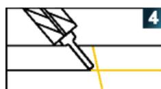
施工打膠並平滑膠體表面
